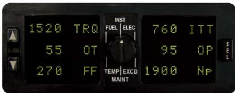
Die Blackhawk Precision Hawkeye DigiLog-Instrumente können mit dem optionalen Digital Display Monitoring Panel (DDMP) kombiniert werden, um herunterladbare Überschreitungsaufzeichnungen, Speicherungen und Wiedergaben bereitzustellen.
